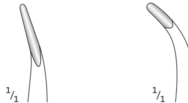
KLEINERT-KUTZ leicht geb. – slightly curved 2x13 mm stark gebogen – full curved 3x8 mm
